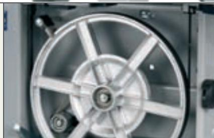
Посредством перекидывания клиновых ремней в нижнем роликовом отделении можно выполнять предварительную настройку на одну из двух скоростей для идеального приспособления к распиливаемому материалу.
