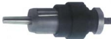
Быстрая развальцовка на конус сердечника вальцовок этого типа позволяет выполнять полное расширение труб при минимальной величине хода веретена. Веретено крепится в задней части вальцовки для уменьшения длины самой вальцовки; кроме того, это позволяет использовать вальцовки данного типа для развальцовки труб вблизи от мест их резкого изгиба.
