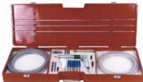
Комплектация поставки системы определяется по желанию заказчика. В комплект входят привод (C-10 или CP-315), ведущие и ведомые штоки и соединительные элементы для них (их точное число зависит от длины труб, которые необходимо очищать), а также чистящие инструменты (щетки, сверла и инструменты для окончательной очистки труб).
